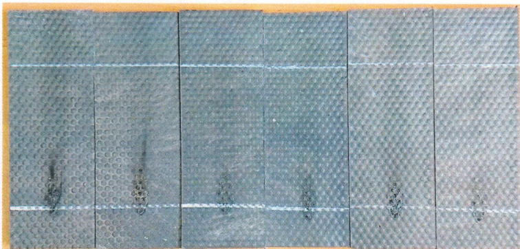
Vzorky Podlahové desky z recyklovaného PVC tloušťky 12 mm po zkoušce - expozice plochy
